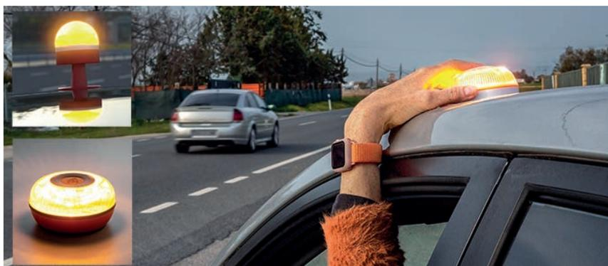
Las V16 geolocalizadas avisan de dónde se ha producido el incidente y, a través de DGT 3.0, a los demás conductores
