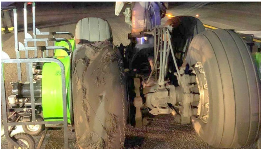
Estado de la rueda y parte del tren de aterrizaje dañados
